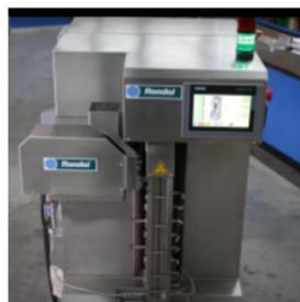
▲ Rondol Industrie a mis au point une micro-extrudeuse verticale en vue réaliser des petites séries de médicaments. - Photo : © Rondol Industrie
