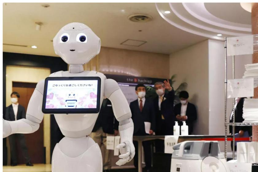
Le robot Pepper, capable de lire les émotions de ses interlocuteurs grâce aux algorithmes. © Kyodo/MAXPPP
