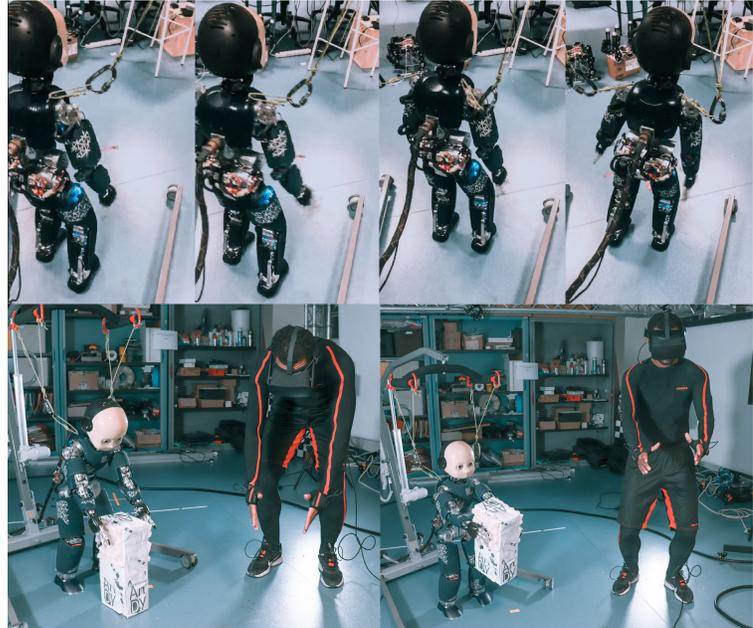
Scénario typique de télé-opération humanoïde : un opérateur porte une combinaison de capture du mouvement et un casque de réalité virtuelle ; il déplace le robot puis peut exécuter des tâches « corps complet ».
