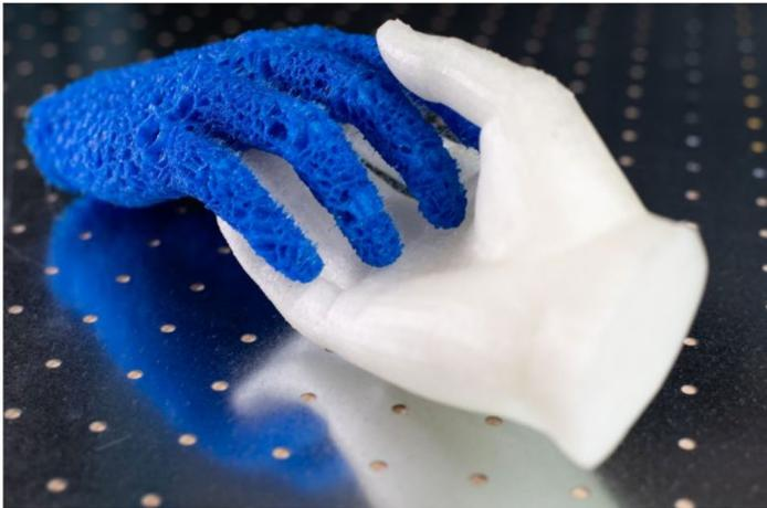
Exemple d'objets imprimés en 3D par l'équipe MFX avec le remplissage Polyfoam. La main bleue montre le remplissage présent dans la main blanche : grâce à ce remplissage orienté et à un filament flexible, les doigts de ces mains peuvent se plier. Photo Inria / D. Betzinger
