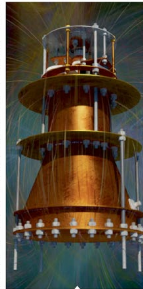
Les micro-ondes piégées dans le cône tronqué produiraient en continu une minuscule poussée.
