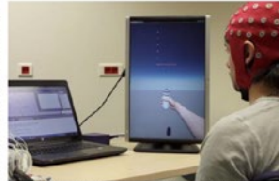
Illustration d'une interface cerveau-ordinateur pour la rééducation post-AVC. L'utilisateur imagine compresser une bouteille. La main virtuelle effectue le mouvement proportionnellement à la qualité de l'imagination motrice mesurée par électroencéphalographie. Photo DR
